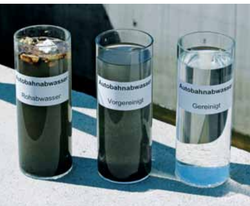
Autobahn-Strassenabwasser (v. l.): ungereinigt, vorgereinigt und gereinigt.
