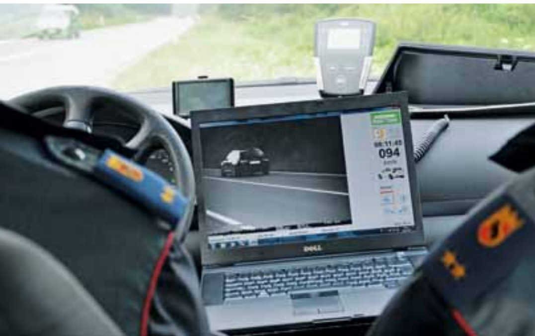
Ein mobiles Radar-Gerät mit direkter Anzeige auf dem Laptop.
