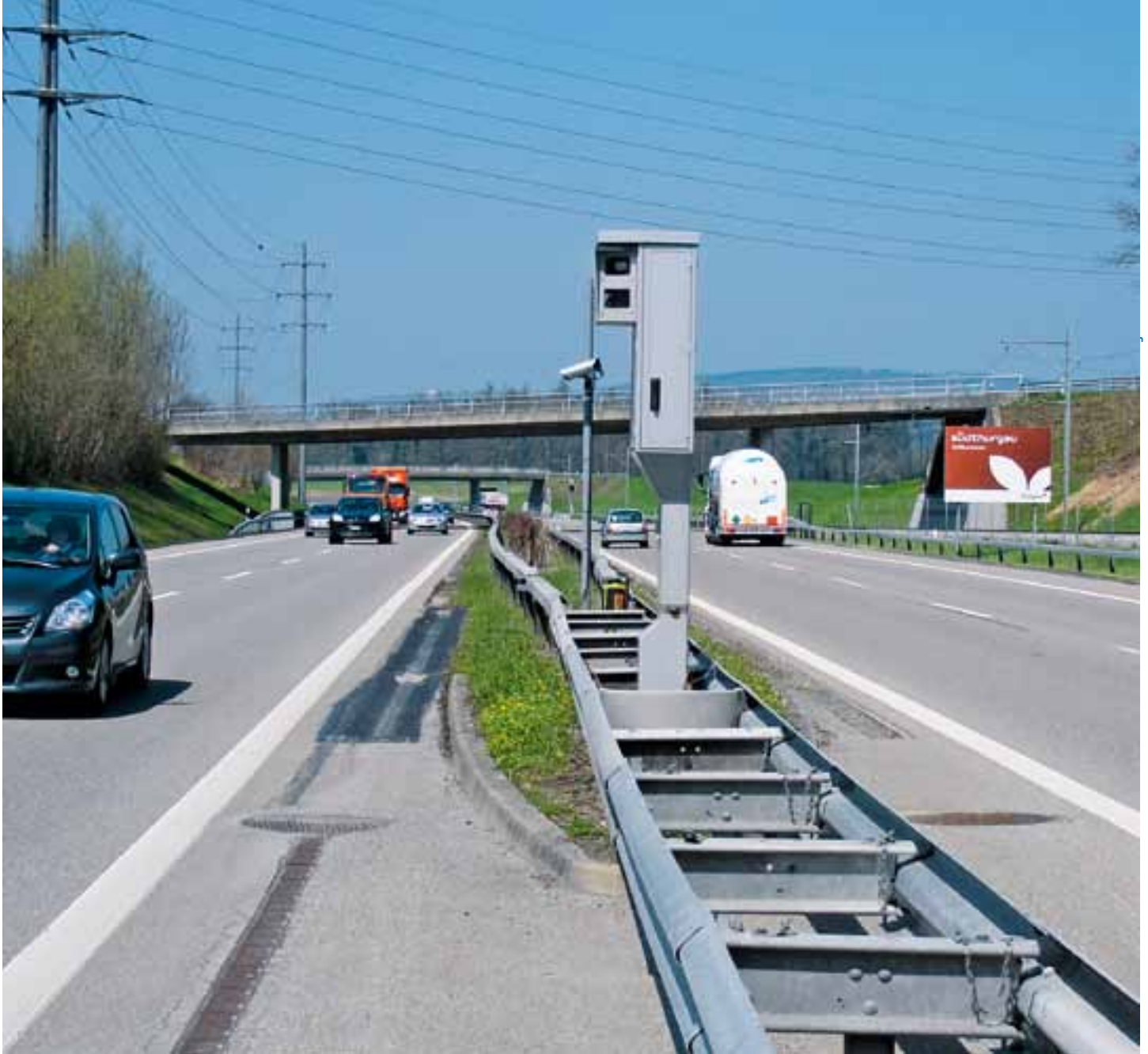
Geschwindigkeitskontrolle mit einem Lasergerät.
