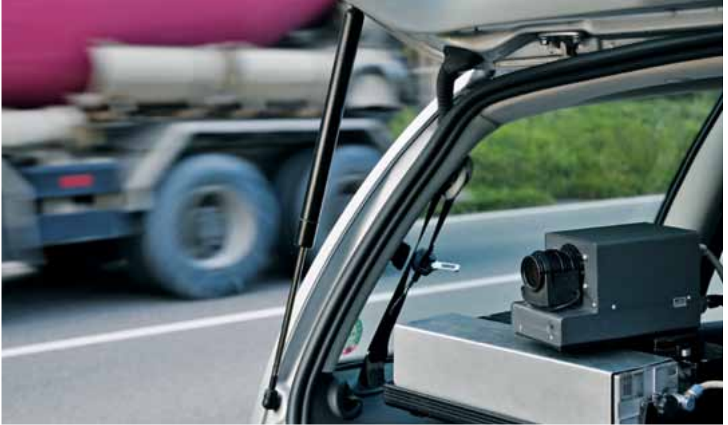
Ein mobiles Radar-Gerät im Fahrzeugheck.
