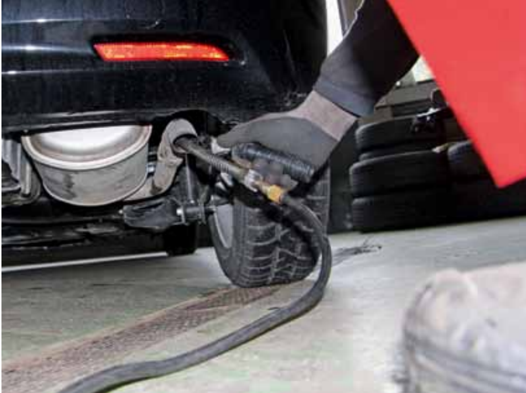
Mit einer speziellen Sonde im Auspuffrohr werden die Abgaswerte gemessen.
